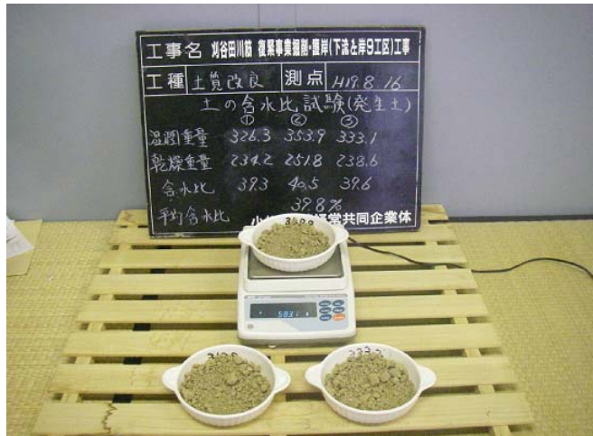
写真-1 改良前含水比測定状況
