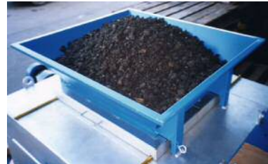
ファルコン投入口
