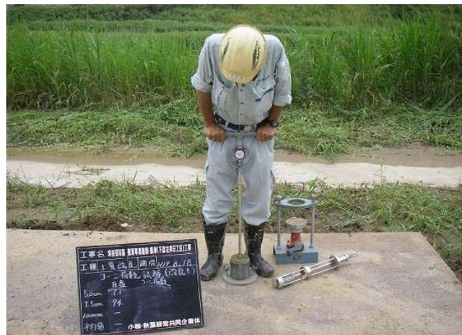
写真-3 改良土 強度測定状況
