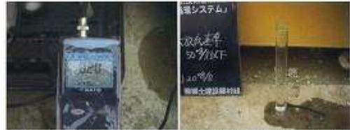
中和完了 (PH=8.20) 濁度測定 (簡易法: ss=20mg/L)
