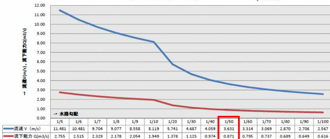
鋼製かけひタイプ水路 流下能力 ( B 0.6m × H 0.5m )
