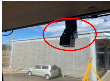
②オペレーター目線の映像を取得する、重機内のカメラ
