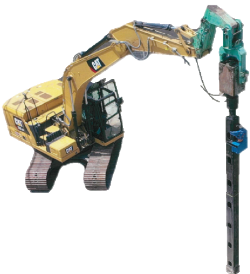
図-3 施工機械の一例 (施工機としてバックホウを利用した場合)
