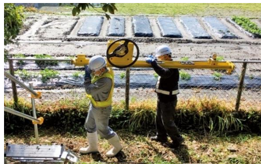
写真1 人肩運搬状況(分解重量48kg)
