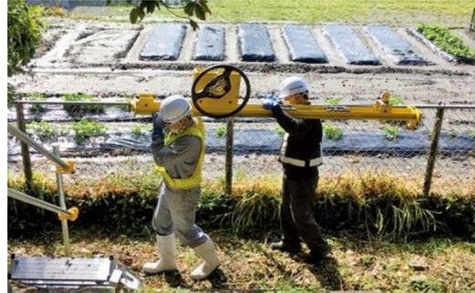
写真1 人肩運搬状況(分解重量48kg)
