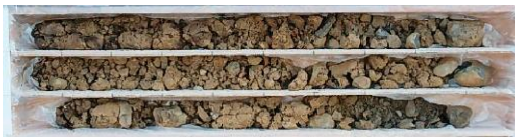
打撃式簡易ボーリングで採取したコア(コア採取率70~80%)
