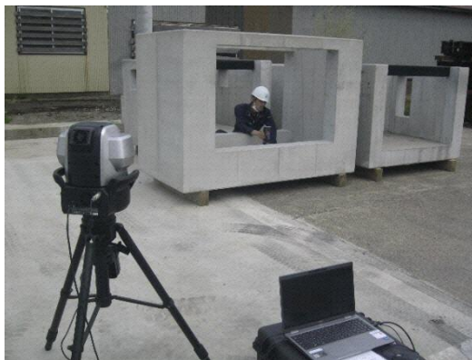
※三次元測定機を使った寸法測定
