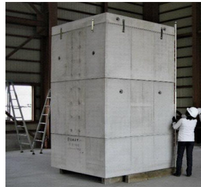
※蓋＋上部＋中部＋下部の高さ測定 (可変型集水枡 1500×1400×3100+蓋200:4分割)
