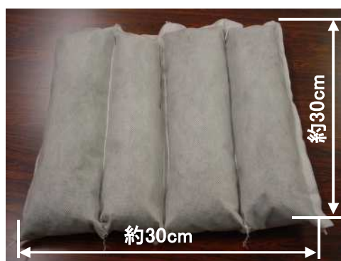
中空ペレットを不織布で覆った排水マット (30cm×30cm×厚10cm—約1.8kg)
