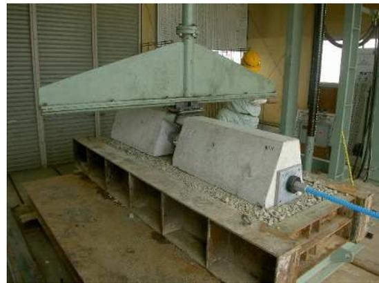
図4 曲げ破壊試験状況
