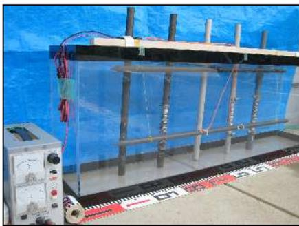
ミニモデルによる電食試験状況
