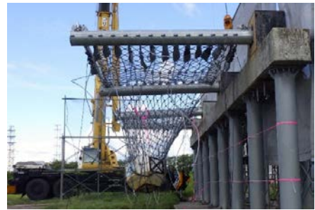
実規模衝撃実験の状況
