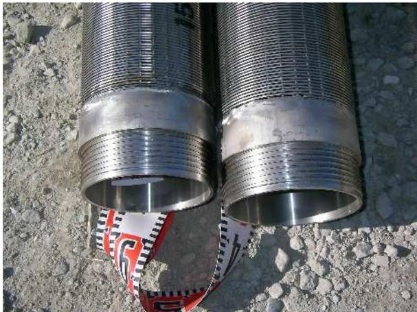
W.KVNの接合部構造(W.KVN側 ネジ加工部)
