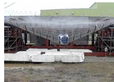
衝突の瞬間のせり出し状況
