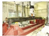
支柱曲げ実験
