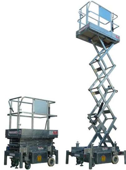
仮設間仕切り設置・撤去、コンクリートブロック間仕切り撤去、天井ブレース取り替え・方杖新設、天井(鉄骨・デッキプレート現し)の塗装 等に使用 ※天井高:約4m
