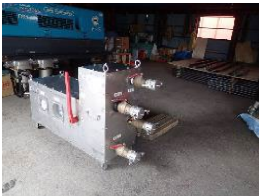
気水混合装置
