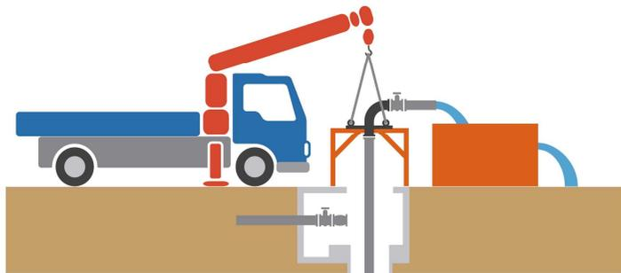
通常、揚水試験などの井戸点検時にはポンプを引き上げて行う必要があります。作業に時間がかかるうえに、ポンプを引き上げるクレーンのためのスペースが必要でした。
